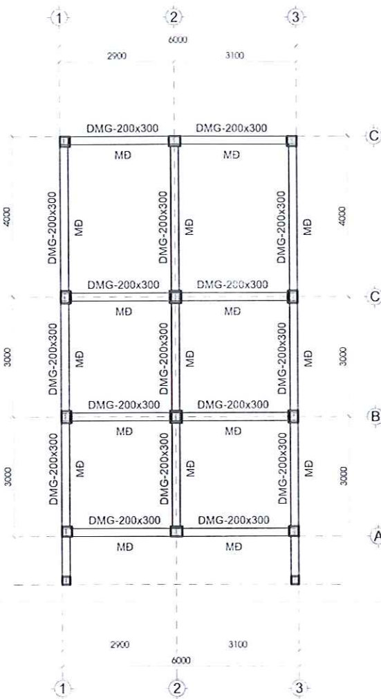
MẶT BẰNG DẦM MÓNG
